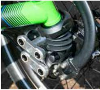
Mit Faltgelenk für einfachen Transport. Unten: Feine, hochwertige Parallelogramm-Federung mit Elastomer-Dämpfer.
