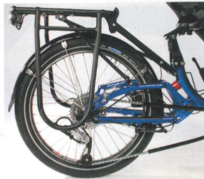
Links: Eine Parallelogrammfederung sorgt für viel Komfort auch im vorderen Bereich des Rades. Rechts: Der Gepäckträger ist aufwendig montiert, der Hinterbau kann so frei federn.
