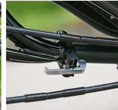
Hier knicken! Weiche Kettenführungen und Compact Flat Twist-Gelenk
