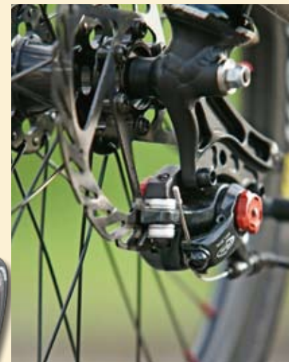
Die einzeln bedienbaren Scheibenbremsen eröffnen besonders in Kurven neue Möglichkeiten.
