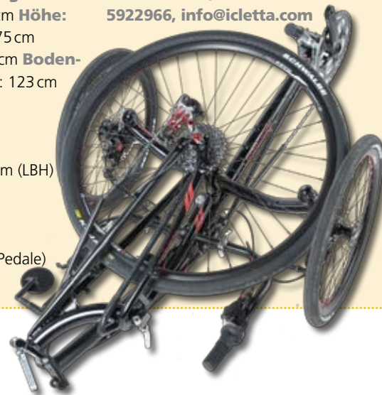
Die einzeln bedienbaren Scheibenbremsen eröffnen besonders in Kurven neue Möglichkeiten.
