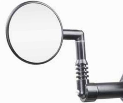
Der Mirrycle Mountain Spiegel wird am Lenkerende, oder wenn die Lenkerenden bereits zum Beispiel durch Lenkerendschalthebel belegt sind, an einem speziellen Spiegelhalter befestigt. Durch die verschraubte Bauweise lässt sich der Spiegel vertikal und horizontal verstellen und vibrationsarm verklemmen. Das konvexe Spiegelglas misst beachtliche 75 mm Durchmesser.
