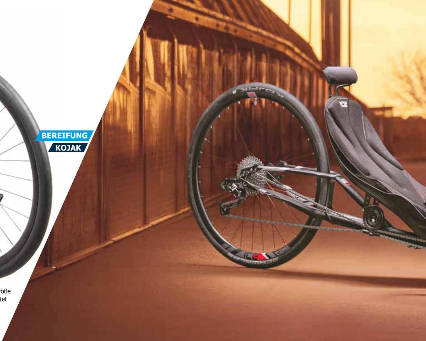
**1** Das Hinterrad kommt in der für Rennradfahrer vertrauten Laufradgröße 622. Das sorgt für Laufruhe, bügelt kleinere Unebenheiten aus und bietet die bekannten Entfaltungen eines herkömmlichen Rades.
